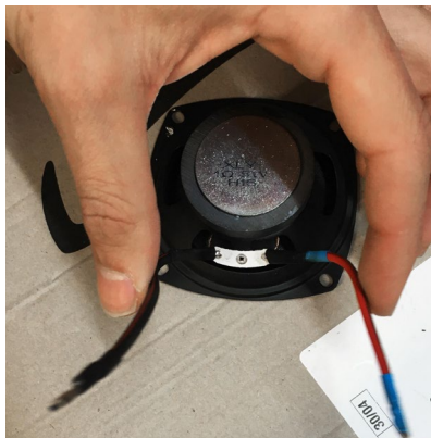
Ejemplo de altavoz con soldadura Fig. 80. (2021)
