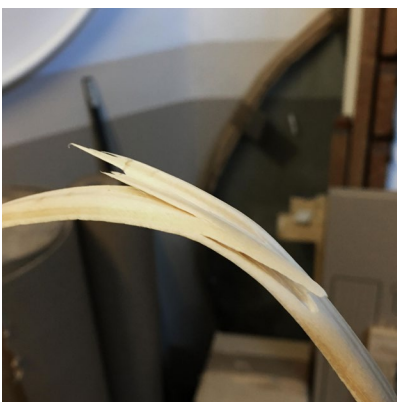
Rotura en proceso de combado Fig. 53. (2021)
