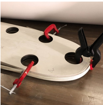
Prueba de curvatura con plantilla Fig. 50. (2021)
