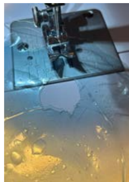
Figura 142: Prueba cosiendo biomaterial fallida.
